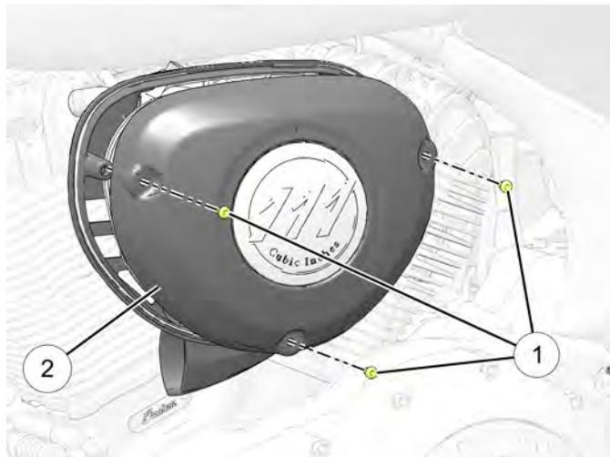
2. Retirer les trois vis de filtre à air ③ et retirer l'ensemble de filtre à air.
