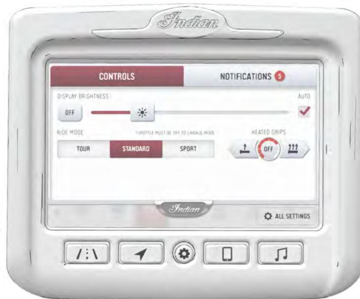
Depuis le panneau des commandes, on peut accéder aux réglages, régler la luminosité de l'écran, sélectionner le mode de conduite et les commandes de climatisation du véhicule.
